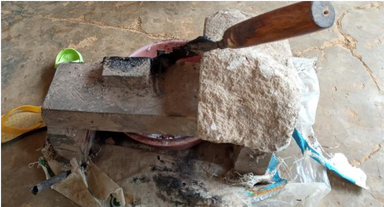
Gambar 5.7. Kacep , Alat Pengupas Jambu Mete
