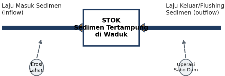
Gambar 4. Contoh Stock and Flow Diagram (SFD) sederhana untuk stok sedimen pada waduk
